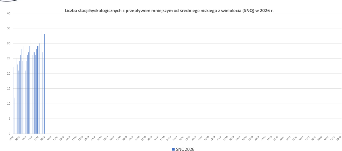
Ryc. 2. Liczby stacji z przepływem poniżej średniego niskiego przepływu (SNQ), czyli umownej granicy suszy hydrologicznej w 2026 roku
