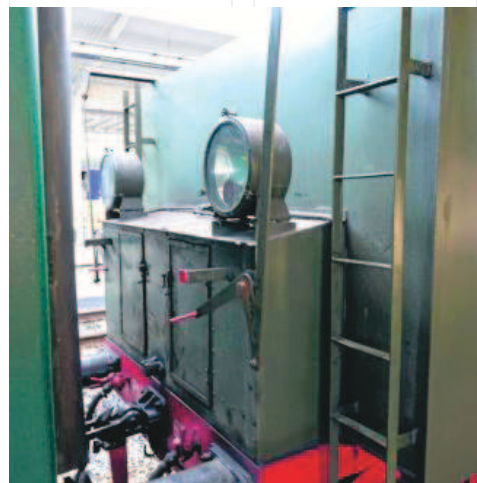
Tender lokomotywy, czyli wagon do przewozu węgla
