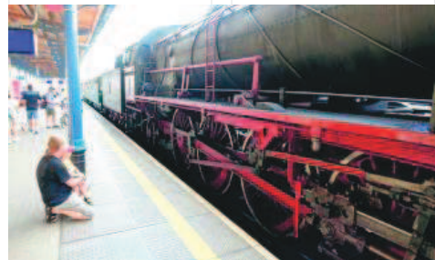
Skład prowadził jedyny sprawny parowóz Pt47-65 zachowany w parowozowni Wolsztyn. To lokomotywa pośpieszna polskiej konstrukcji produkowana w latach 1948-1951 dla Polskich Kolei Państwowych. Lokomotywy tego typu eksploatowano w ciężkim ruchu pasażerskim na wszystkich liniach głównych
