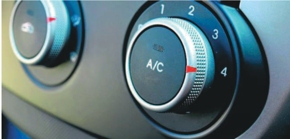
► Klimatyzacja pomaga nie tylko schłodzić wnętrze, ale również odpowiada za przejrzystość szyb, usuwając parę
