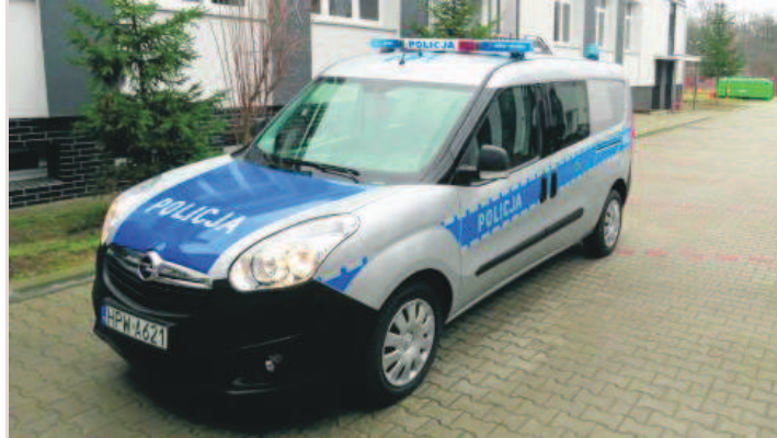
► Auto ma sporą część bagażową, a także przesuwane drzwi. Ma silnik benzynowy o pojemności 1,4 l i mocy 120 KM. Pojazd jest lekki, może wjechać w trudny teren
